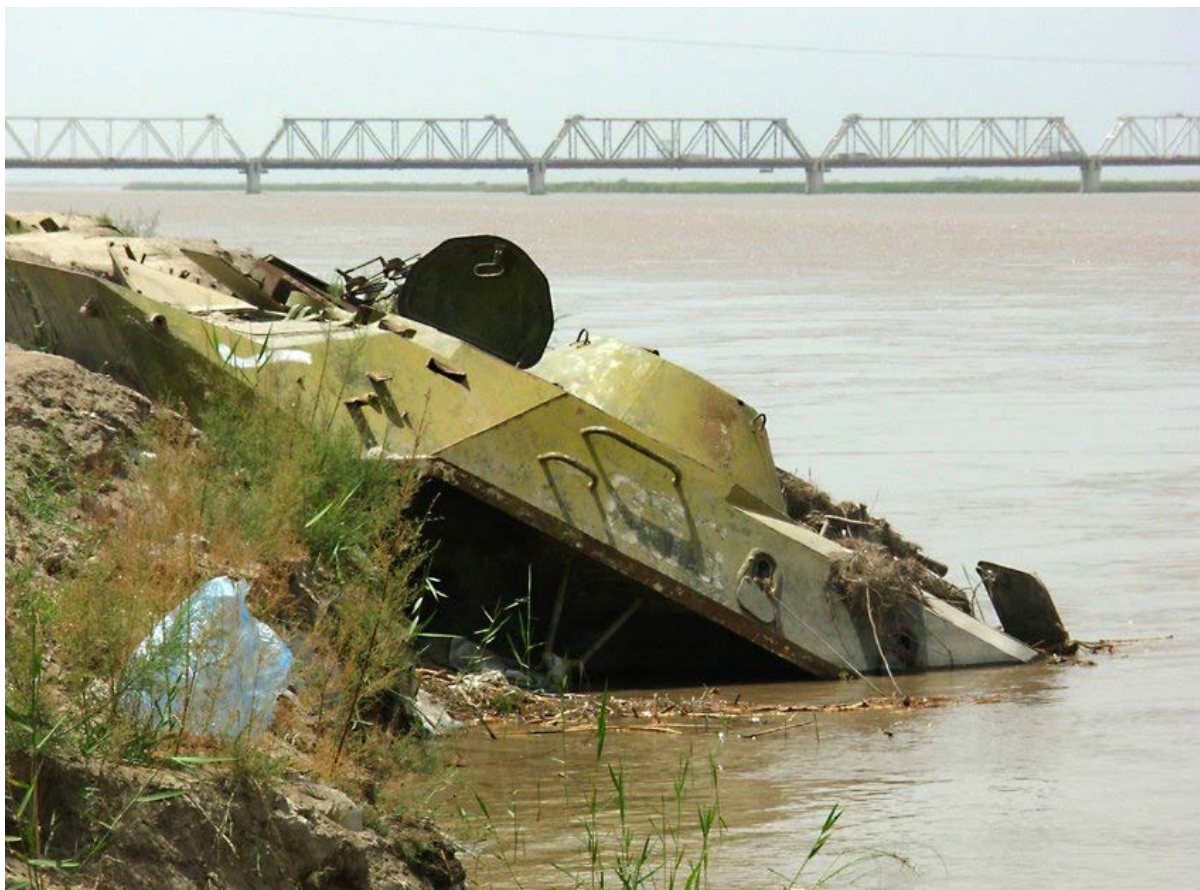
Шакли 3.14: Акси тонк, ки ба Омўдарё аз самти Афѓонистон ба найси талош барои монешшудан аз даст додани хок ва таваќќуфи фарсоиши дарёи Омў аз самти Афѓонистон ба дарё тела карданд.
