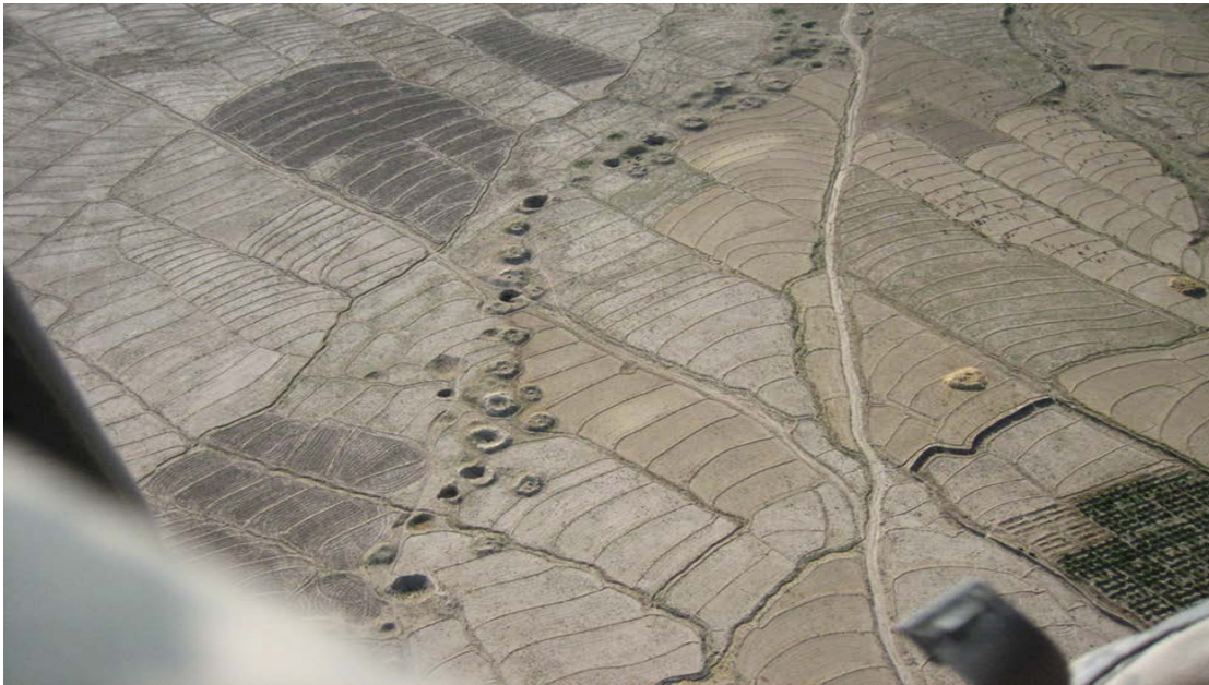
شکل 15,12. سطح کی طرف سے کاریز کے سوراخوں کی تصویریں، جن میں کچھ بند کر دی گئی ہیں کیونکہ ان کے سرنگ اندر سے گر گئے تھے اس لئیے ان کے نزدیک ایک اور سرنگ کھودی گئی ہے۔
